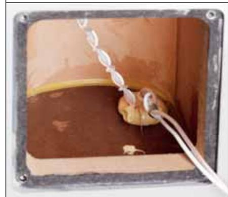
*Auch im halbkreisförmigen Mitteltongehäuse findet sich keine Spur von Dämmmaterial. Gut zu sehen: die Spezialverkabelung von Shunyata*
