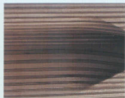
Lumen White의 스피커를 위해 사용된 Plywood의 단면 사진. MDF와 같은 일반적인 인공적 나무 소재가 아닌 각기 다른 재질을 적층구조로 제작한 고급스런 천연 나무 소재 고도의 가공 처리를 통해 유닛형으로 성형하여, 내외 개성음을 제작하는 데 한 걸 가까이 시간이 걸린다고 한다.
